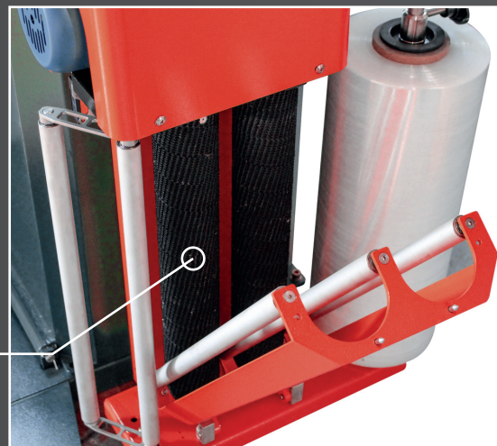
Sistema de passagem simplificada do filme
